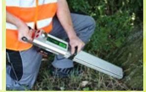
Mesure de la résistance du bois (densité) par perçage.
